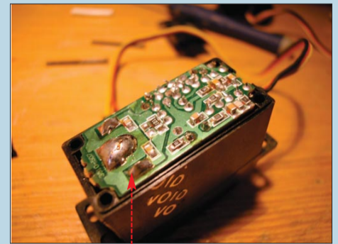
przerobić serwomechanizm, aby można go było zastosować w robocie minisumo.
